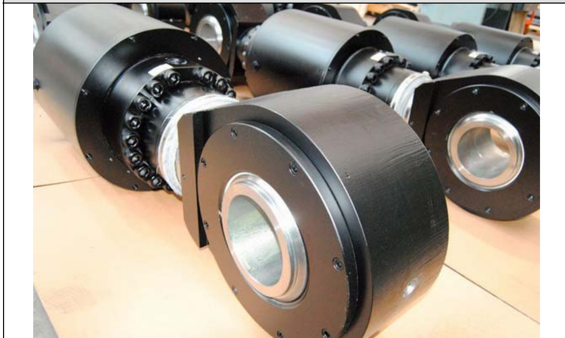
سیلندر با لولای خاص سر میل
