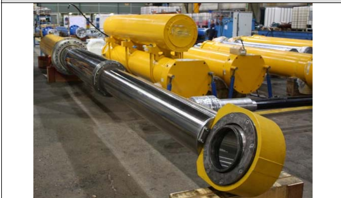
سیلندر تلسکوپی ۲ مرحله ای با طول و قطر بزرگ
