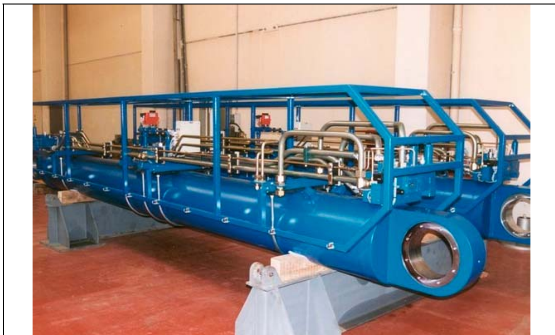
سیلندر همراه با بلوک و لوله کشی
