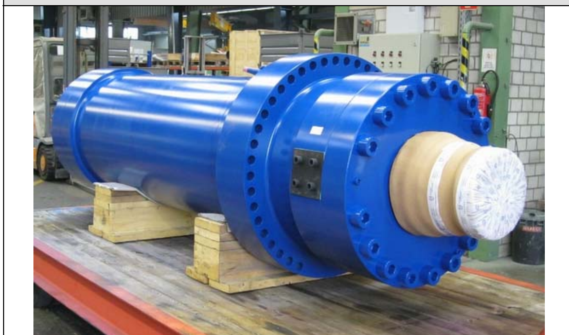
سیلندر هیدرولیک با قطر پیستون 70cm
