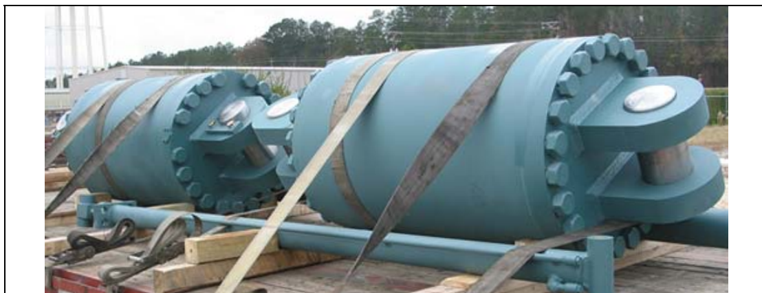
سیلندر دو سر لولا با قطر پیستون 80cm
