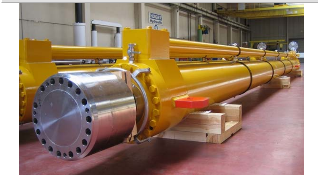
سیلندر با لوله کشی قطور
