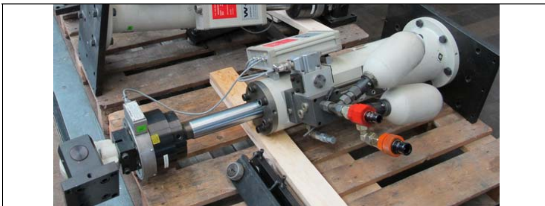
سروو سیلندر همراه با آکومولاتور، شیر سروو و لودسل
