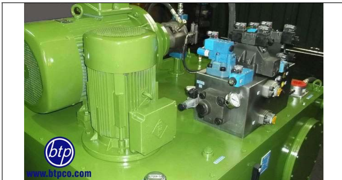
استفاده از پرشر سوئیچ تک کنتاکت برند دوپلماتیک در یونیت هیدرولیک
