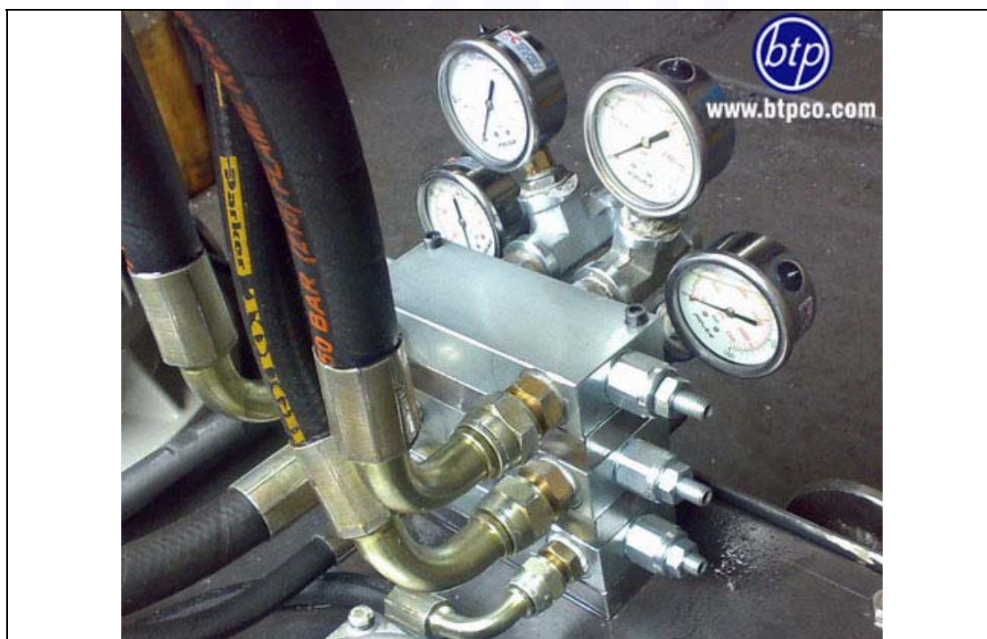
استفاده از شیر ترمزی برای جلوگیری از فرار بار وینچ کشتی - سال ۸۸
