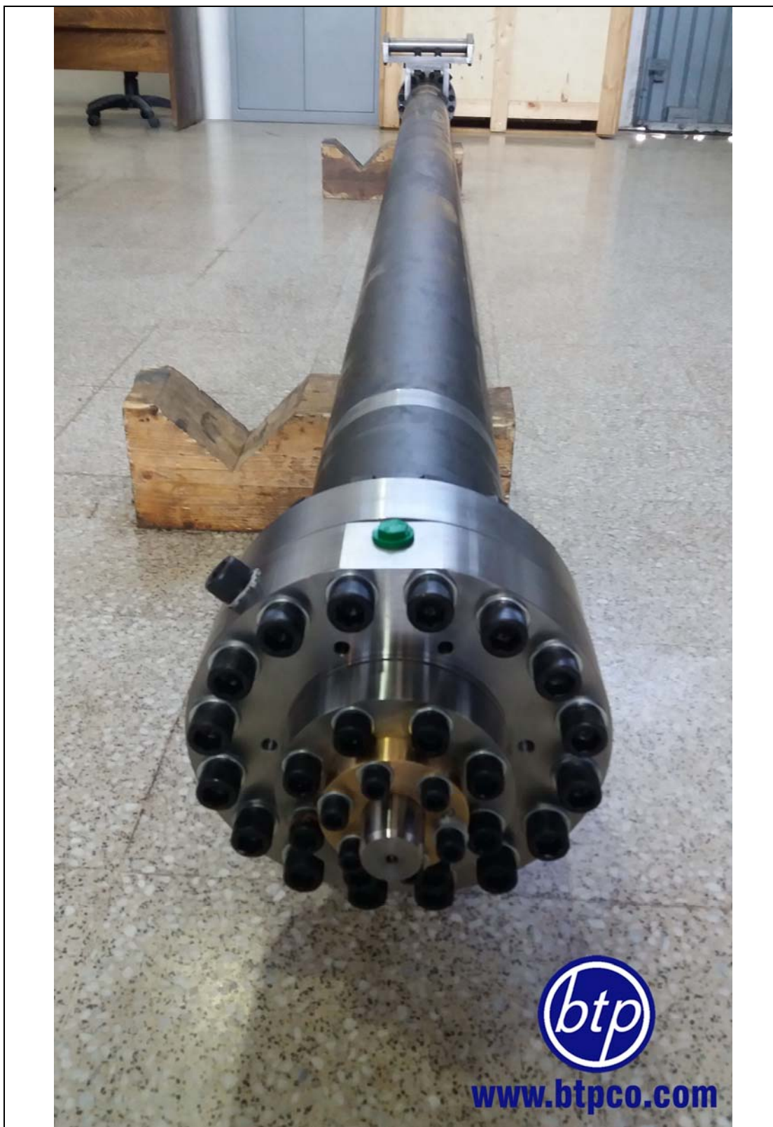
ساخت سیلندر تست تحت فشار 500 bar
