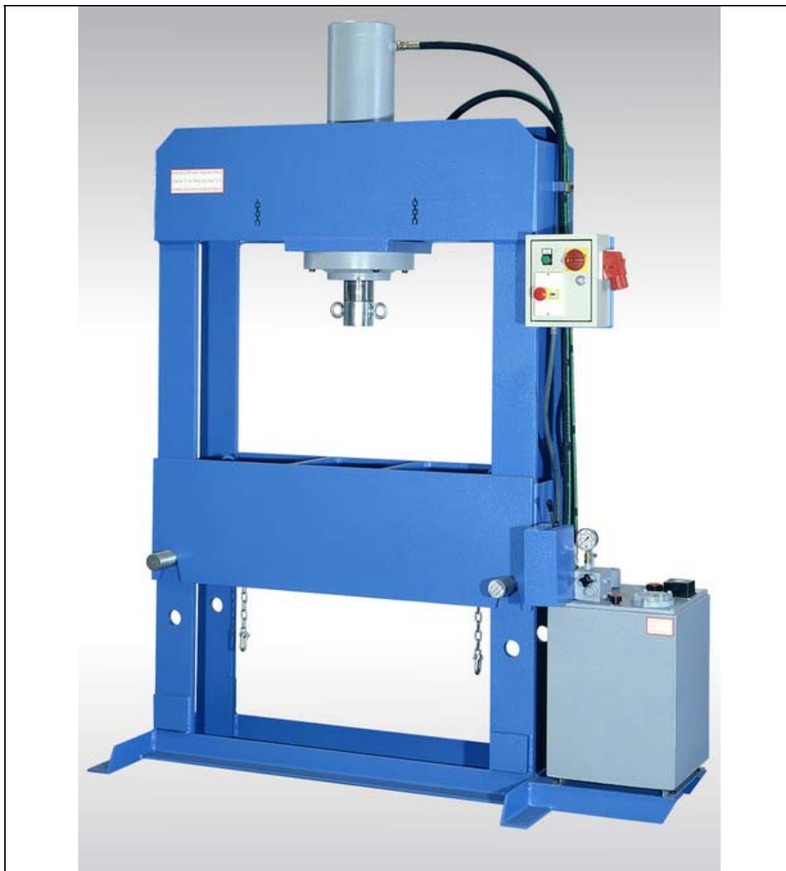
پرس هیدرولیک کارگاهی ساده برای مونتاژ و جازدن قطعات
