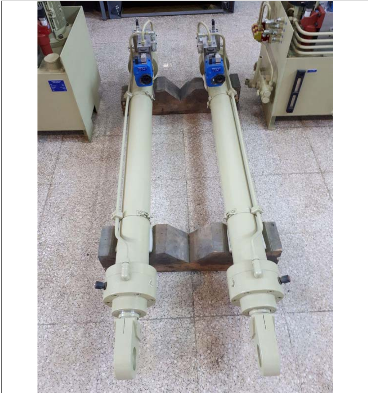
سیلندر خاص شامل بلوک نصب شیرآلات با فشار کاری 200bar - موبایل هیدرولیک
