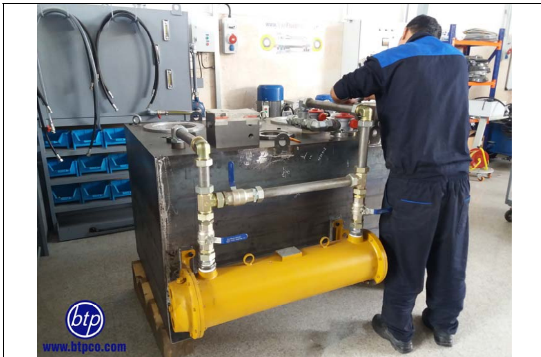
تیوب سایز 42mm و اتصالات هیدرولیک سایز 1-1/2 اینچ (به سفارش شرکت گواه صنعت)
