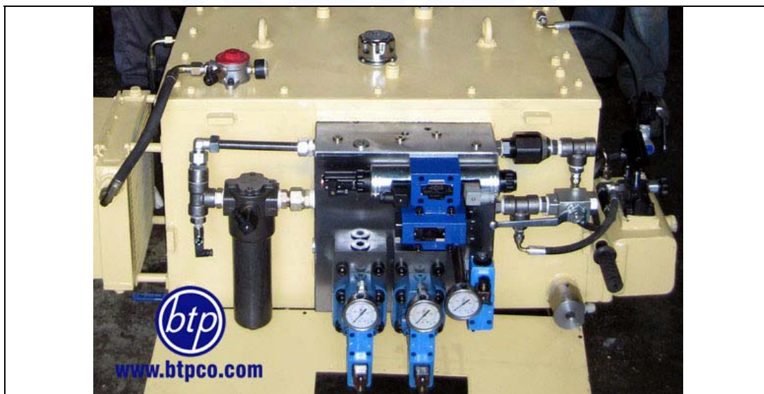
تیوب سایز 20mm و اتصالات هیدرولیک سایز 1 اینچ ( یونیت هیدرولیک دستگاه بالابر مخصوص)
