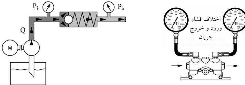
در صورتی که بتوان اختلاف فشار ورود و خروج ( $P_o - P_i$ ) مربوط به جریان عبوری  $Q$  از یک قطعه هیدرولیک را تعیین نمود، با استفاده از رابطه زیر مقدار توان حرارتی در آن قطعه محاسبه می‌گردد.
