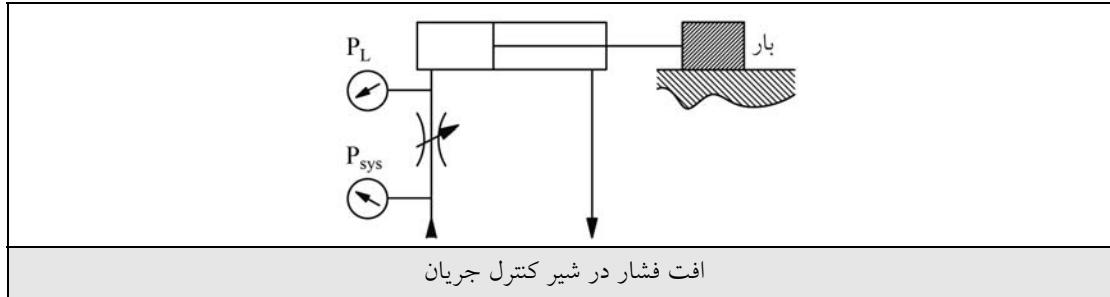
سپس با توجه به دبی عبوری از آن و با استفاده از رابطه (۱) مقدار افت توان به صورت محاسبه می‌گردد. باید توجه نمود مقدار دبی عبوری از شیر کنترل جریان برابر  $Q_{RV} = Q - q$  که در آن  $Q_{RV}$  دبی عبوری از شیر فشار شکن می‌باشد. مقدار  $q$  را مستقیماً با استفاده از سرعت سیلندر می‌توان تعیین نمود.
