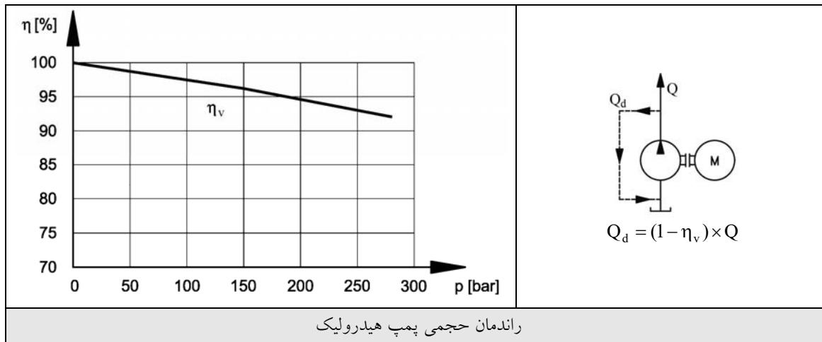
از آنجا که راندمان حجمی پمپها با افزایش فشار کاری کاهش می‌یابد، معمولاً مقدار آن را برای حداقل فشار کاری پمپ (مثلاً 150bar) تعیین می‌نمایند. برای مثال اگر راندمان حجمی یک پمپ با دبی تشوری 40lit/min در فشار 150bar برابر 0.8
