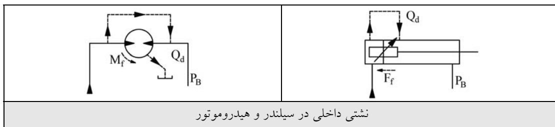
معمولًا در محاسبات سریع برای انتخاب سیلندر یا هیدروموتور فشار پشت ( $P_B$ ) برابر صفر در نظر گرفته می‌شود ولی با توجه به نوع مدار و المانهای موجود در آن ، برای بررسی دقیق لازم است محاسبات بر مبنای اختلاف فشار ورودی و خروجی  $\Delta P = P - P_B$  انجام گیرد.
