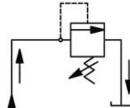
عبور روغن از شیر کنترل فشار
