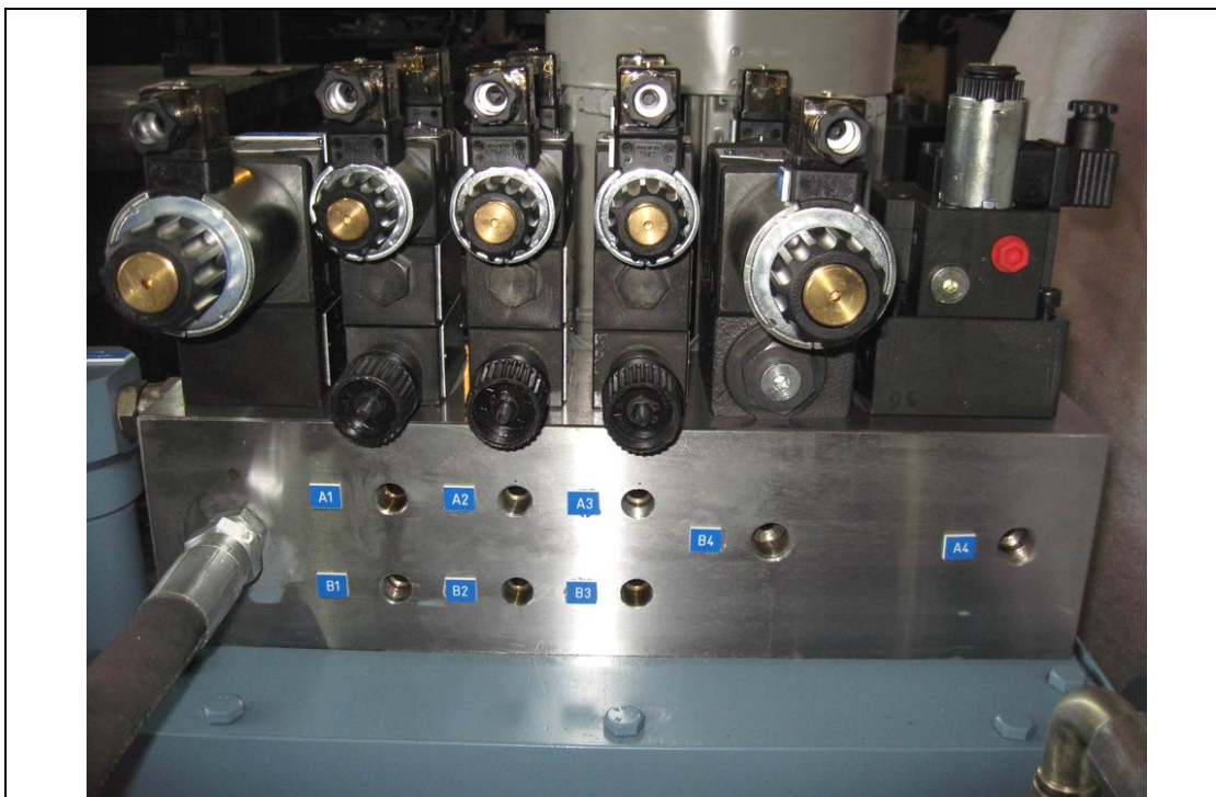
استفاده از شیرهای فلو کنترل مدولار و پروپورشنال برای یونیت هیدرولیک کوره خلاء به سفارش شرکت مپنا
