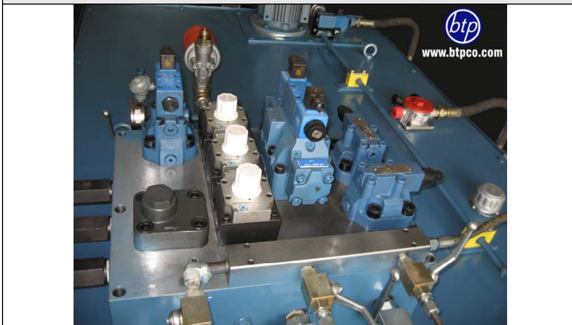
استفاده از شیرهای فلو کنترل Pressure Compensated به صورت موازی به سفارش شرکت کاوش
