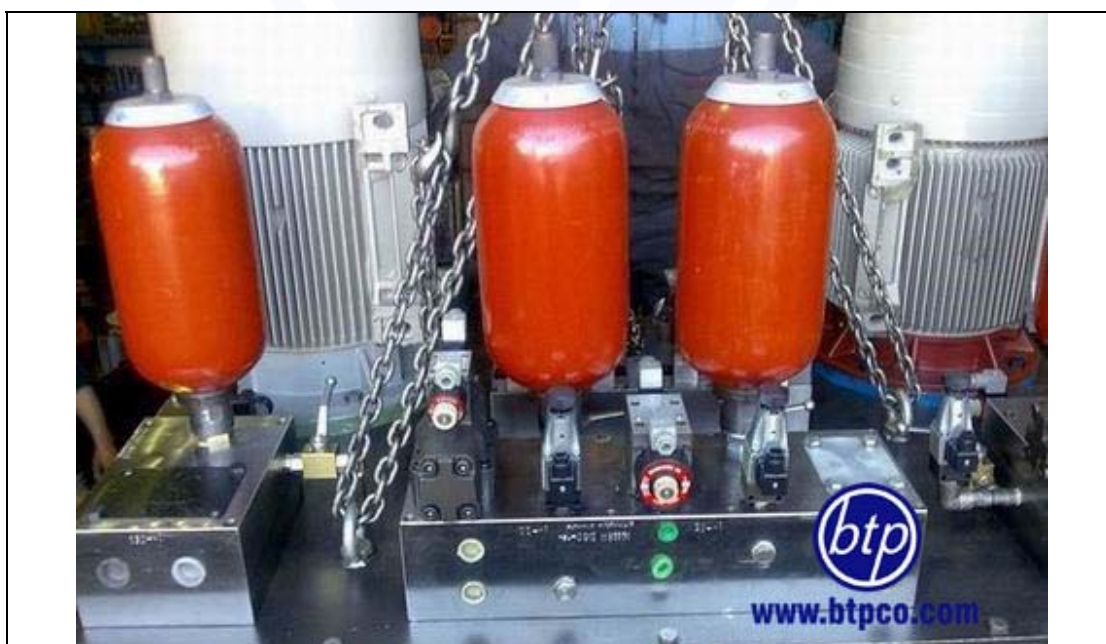
یونیت هیدرولیک مربوط به خط شکل دهی میلگرد - فرایند شارژ و تخلیه آدیاباتیک
