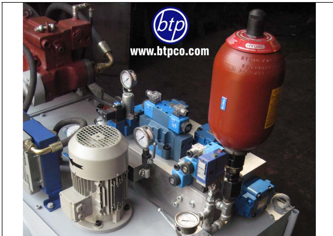
یونیت هیدرولیک مربوط به خط تولید سیمان - فرایند شارژ آدیاباتیک و تخلیه ایزوترمال
