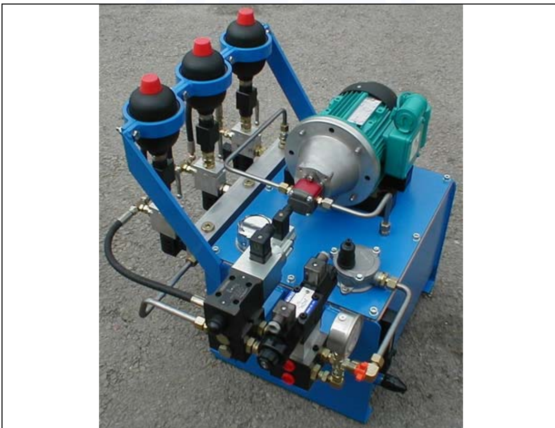
آکومولاتورهای دیافراگمی به صورت موازی در مدار عملکرد شیر پروپورشنال
