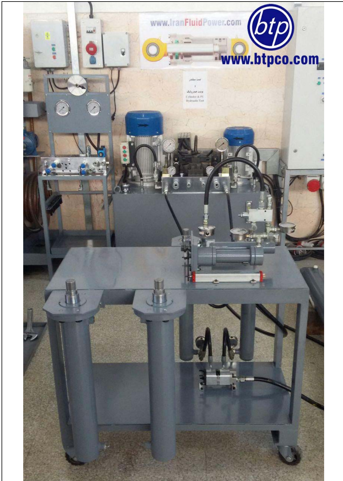
ساخت میز تست حرکت سنکرون سیلندرها (مجهز به خط کش الکترونیک) و فلودیوایدر دنده ای
