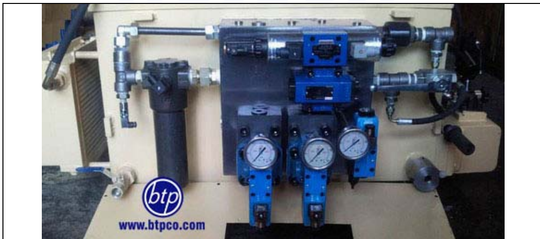
یونیت هیدرولیک شامل خنک کن هوایی مربوط به سیستم بالابر شامل پمپهای واریابل و شیر پروپورشنال
