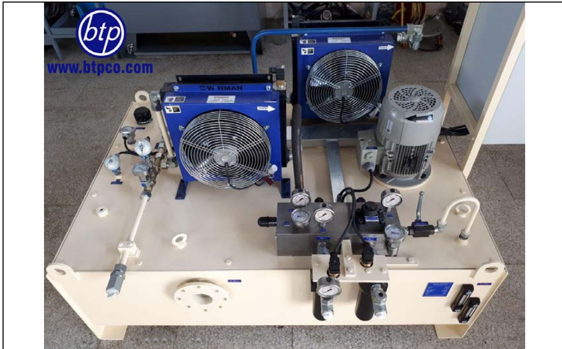
یونیت هیدرولیک شامل دو عدد خنک کن هوایی به سفارش شرکت اکسین گاز
