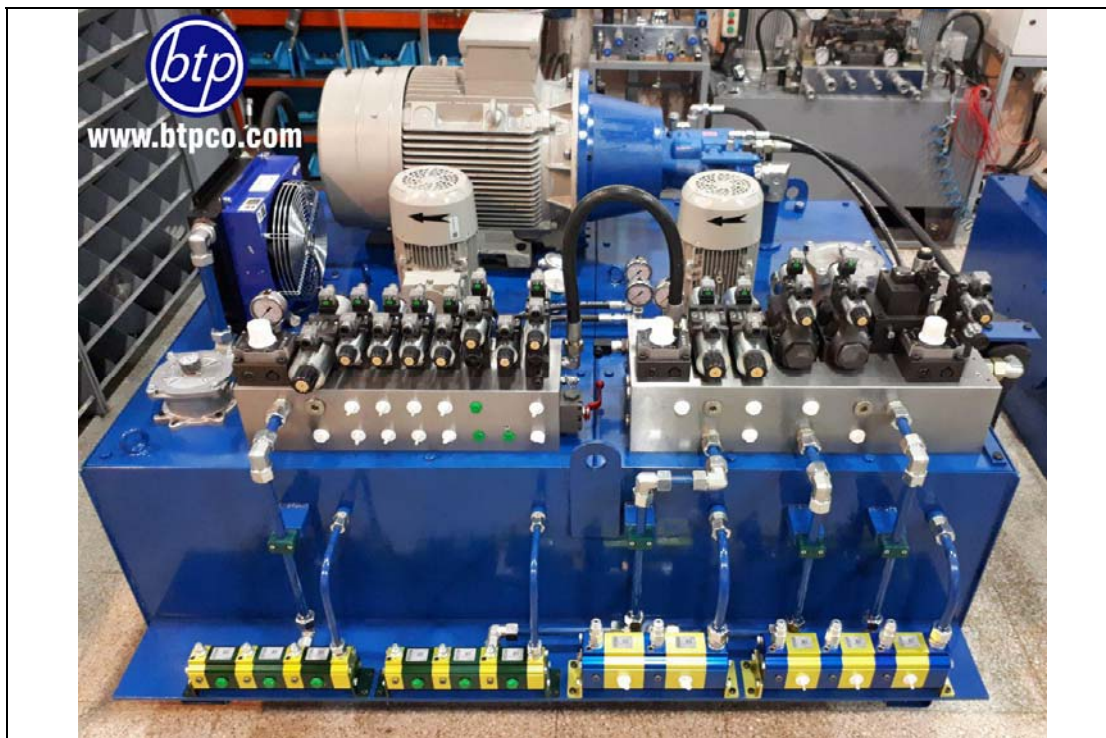
خنک کاری روغن هیدرولیک توسط پمپ مستقل در یونیت هیدرولیک
