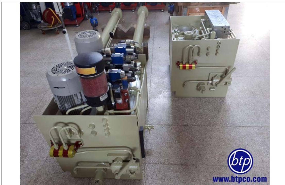
یونیت هیدرولیک شامل دو عدد پمپ و الکتروموتور مستقل مربوط به دستگاه بالابر
