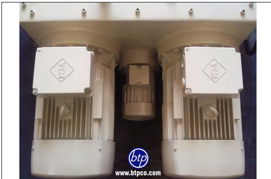
یونیت هیدرولیک شامل سه عدد پمپ و الکتروموتور مستقل مربوط به دستگاه بالابر
