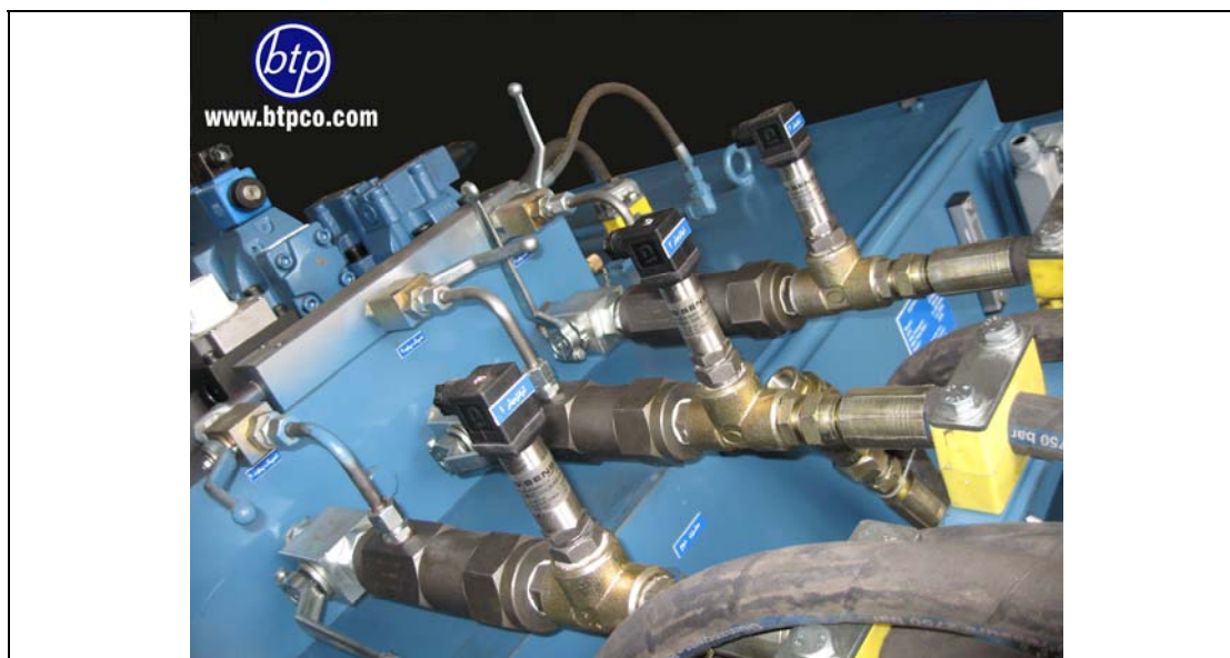
یونیت هیدرولیک موجود جهت انجام تست خستگی مخازن CNG در فشار پائین
